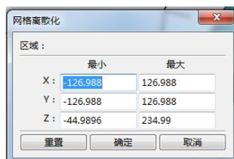
该对话框用于设置预览网格区域的范围，可以指定预览模型空间的一个子区域。点击确定开始划分。点击工具栏
